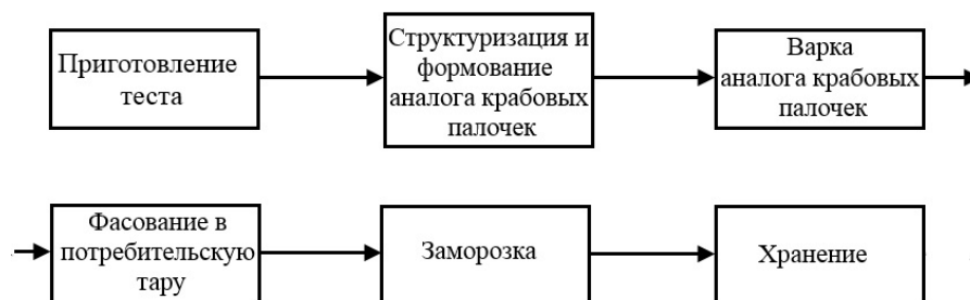
Рис. 3. Схема производства крабовых палочек с насадочным устройством Fig. 3. Traditional scheme of production of crab sticks with a packed device
